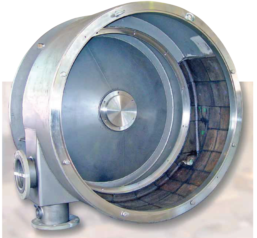
Máy phân loại kết hợp làm bằng thép cao cấp được sử dụng trong ngành công nghiệp giấy - được bảo vệ chống sự mài mòn bằng gạch bazan đúc chảy
