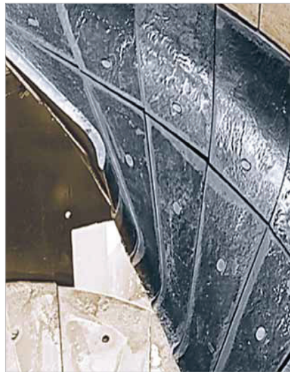
Máy trộn nhựa đường thường chịu hao mòn đáng kể; những chiếc máy được bảo vệ hiệu quả bởi KALMETALL-C
