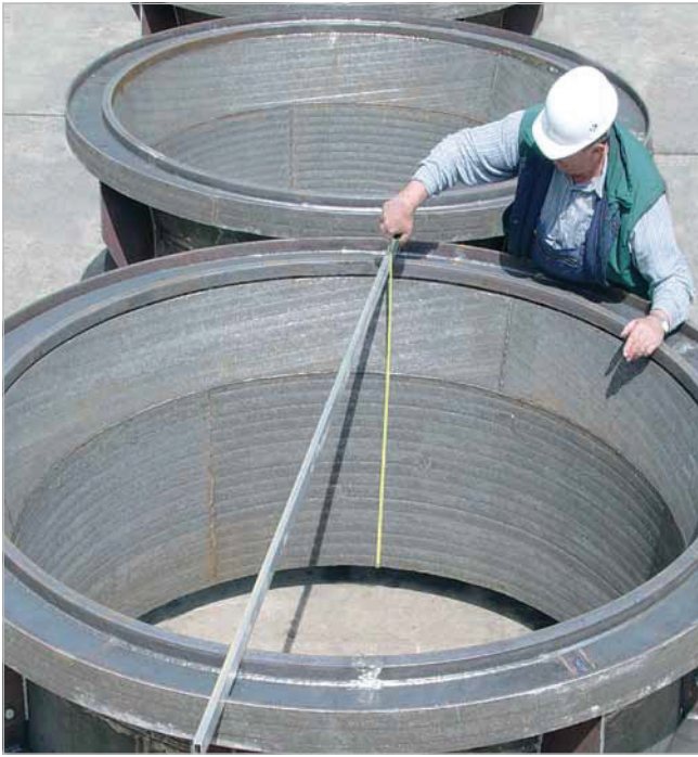
Côn phân ly nghiền xi làm bằng KALMETALL-W 100 như là các cấu trúc chịu lực.
