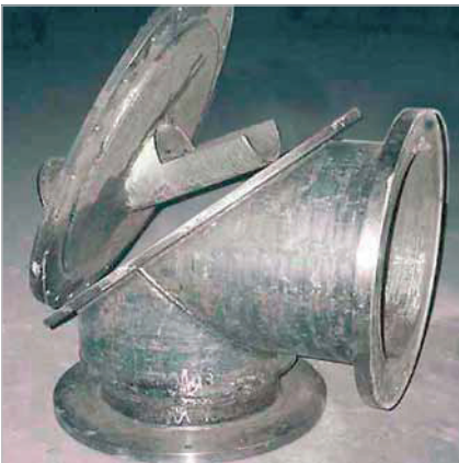
Lò đốt than nghiền được lót KALMETALL-W 145
