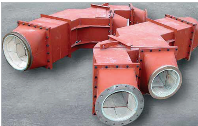
Các hộp phân phối than nghiền được bảo vệ bằng KALCOR cho lớp lót bề mặt lớn và KALOCER để mang lại khả năng chống mài mòn tối đa
