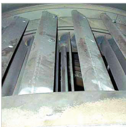
Các cánh dẫn hướng của thiết bị phân ly làm bằng KALSICA-A được vận hành trong máy nghiền than
