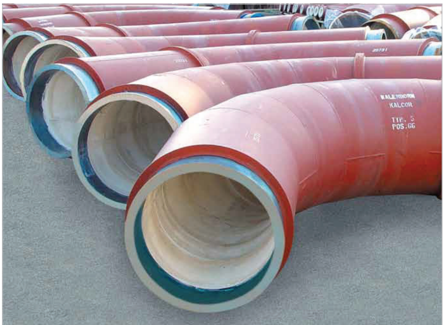
Các khuỷu ống dẫn than nghiền với lót KALCOR zirconium corundum và hàn lên các phần chuyển tiếp không lót.
