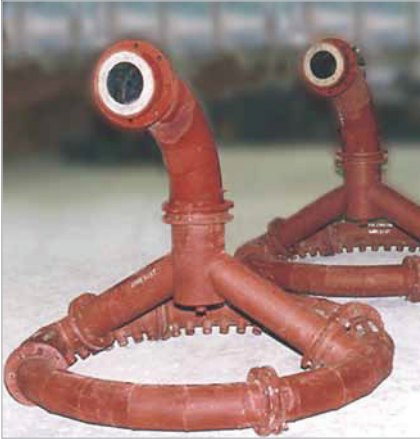
Bộ phận phân ly được cung cấp bảo vệ chống mài mòn ABRESIST
