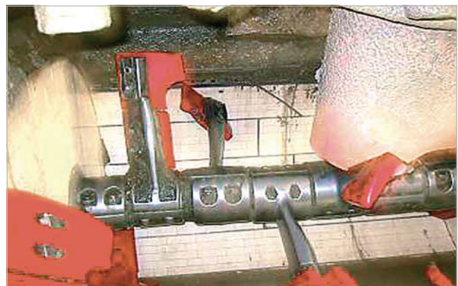
Máy trộn bê tông kiểu trống được lót bằng gốm cao alumina KALOCER; dụng cụ trộn được làm bằng KALMETALL-C đúc cứng và / hoặc nhựa KALEN-PU
