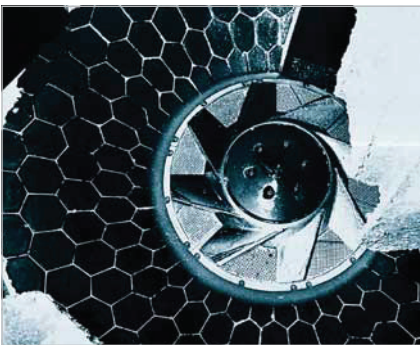
Các kiện giấy thải được trộn để tái chế giấy trong máy nghiền. Vì các kiện chứa tạp chất đáng kể, đáy máy nghiền được bảo vệ lâu dài với ABRESIST.
