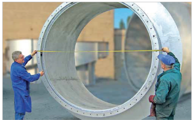
Phân ly của máy nghiền xi được lót bằng KALCRET-BNX, đường kính lên tới 3.200 mm
