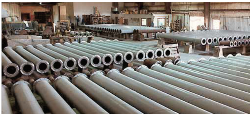
Ống vận chuyển tro thủy lực đang được sản xuất tại nhà máy công ty Abresist Kalenborn ở Indiana, Hoa Kỳ.
