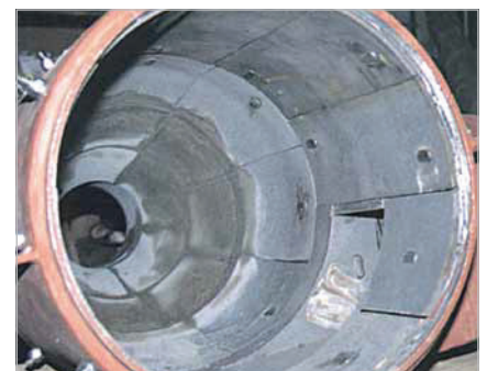
Xyclon được sử dụng trong hệ thống khử nhiễm đất - được bảo vệ hiệu quả bằng KALMETALL-C
