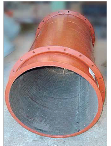
Ống được bọc KALMETALL-W 100 được lắp đặt trong hệ thống thu gom bụi; đường kính trong 400 mm, độ dày hệ thống 8 + 5 mm
