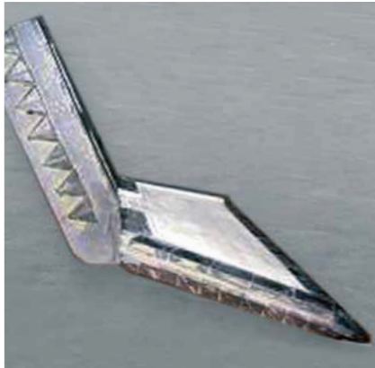
Lưỡi máy trộn với lớp lót kết hợp KALMETALL-HM và KALOCER.
