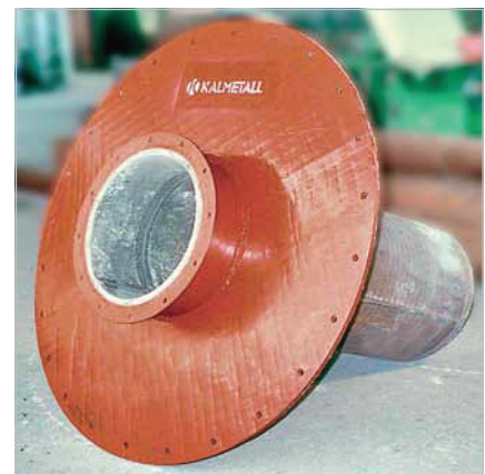
Ống ngậm của xyclon để tách xỉ dạng hạt trong ngành xi măng; KALCRET và KALMETALL-W
