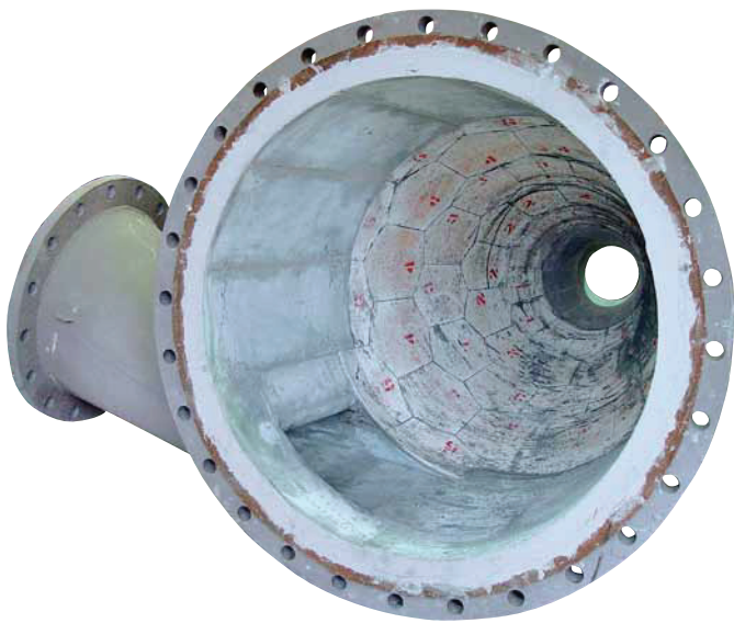
Lớp bảo vệ hiệu quả của một xyclon xử lý cát silic: KALCOR zirconium corundum và gốm silic cacbua KALSICA
