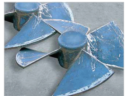
Rôto tuabin làm bằng KALMETALL-C 155
