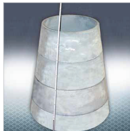
Lớp lót KALSICA-N cho một xyclon xử lý bụi silane; đường kính phễu chính 1.200 mm; độ dày thành 30 mm
