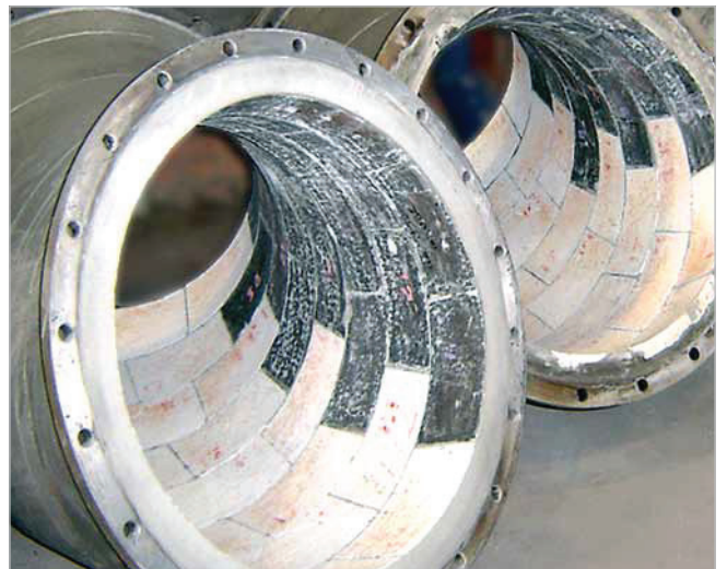
Kết hợp KALCOR với ABRESIST trong một ống dẫn than nghiên ở châu Âu
